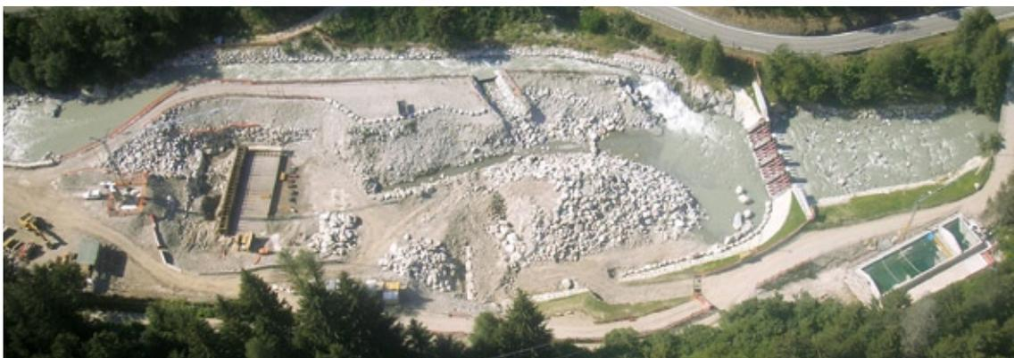
FOTO Area del cantiere di costruzione di una briglia filtrante sul torrente Vermigliana.
