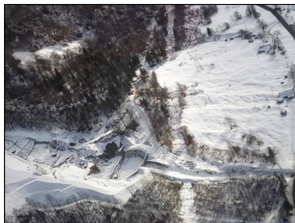
DOPO: la strada provinciale (visibile lungo il bordo destro della foto) è stata protetta tramite la realizzazione di una briglia selettiva e di una grande piazza di deposito.
